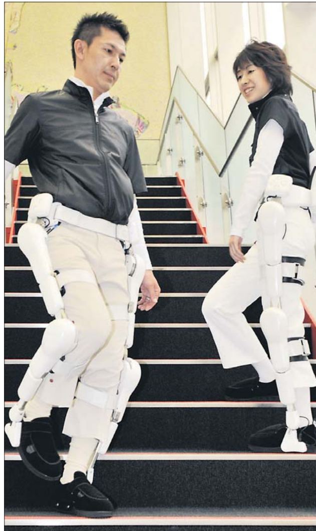
Außen an Beine oder Arme geschnallt, verstärken Roboterteile die Bewegungen ihrer Träger. Elektroden erfassen dazu die Nervenimpulse und leiten sie an die Motoren weiter. Yoshikazu Tsuno / AFP
