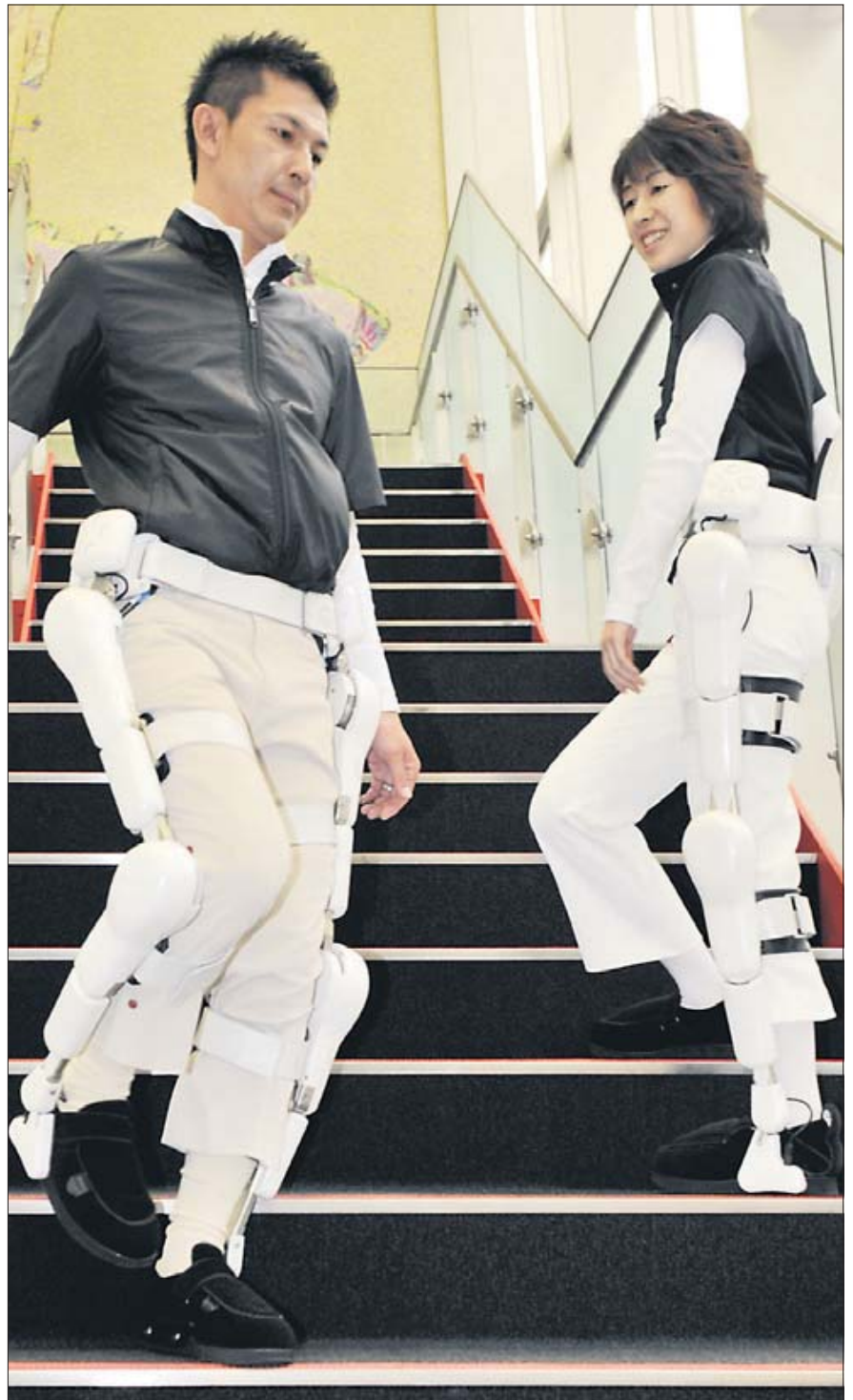
Außen an Beine oder Arme geschnallt, verstärken Roboterteile die Bewegungen ihrer Träger. Elektroden erfassen dazu die Nervenimpulse und leiten sie an die Motoren weiter.
