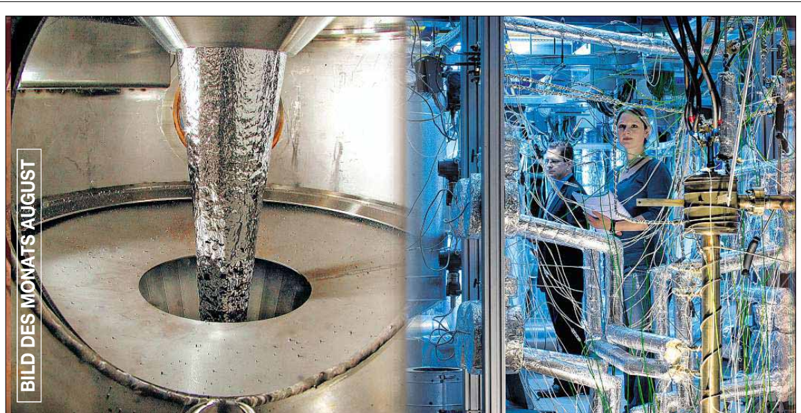
SPEKTAKULÄRES EXPERIMENT: Der weltweit größte Freistrahler aus flüssigem Blei-Wismut (links) hat einen Durchmesser von etwa zehn Zentimetern und ist über mehrere Stunden stabil. Unser Bild des Monats zeigt den Strahl im stabilen Zustand. Das Experiment gelang im Flüssigmetall-Labor KALLA des Karlsruher Instituts für Technologie (rechts). Dort laufen auch die Studien zur Auslegung des Metalltargets im Zuge der Transmutationsforschung. Fotos: KIT
