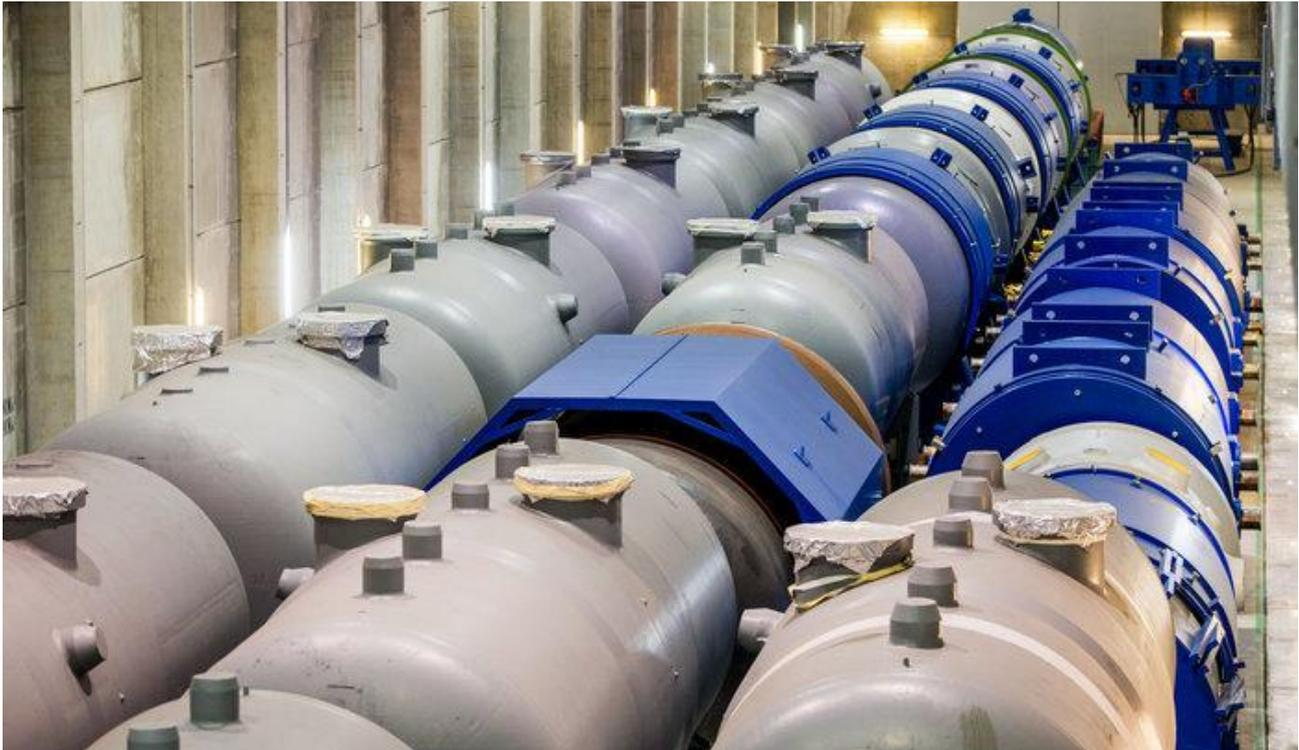
Radioaktive »Großkomponenten« : Reaktoren und Dampferzeuger aus rückgebauten Atommeilern, die auf dem Gelände des ehemaligen AKW Lubmin zwischengelagert werden Foto: Jens Büttner/dpa
