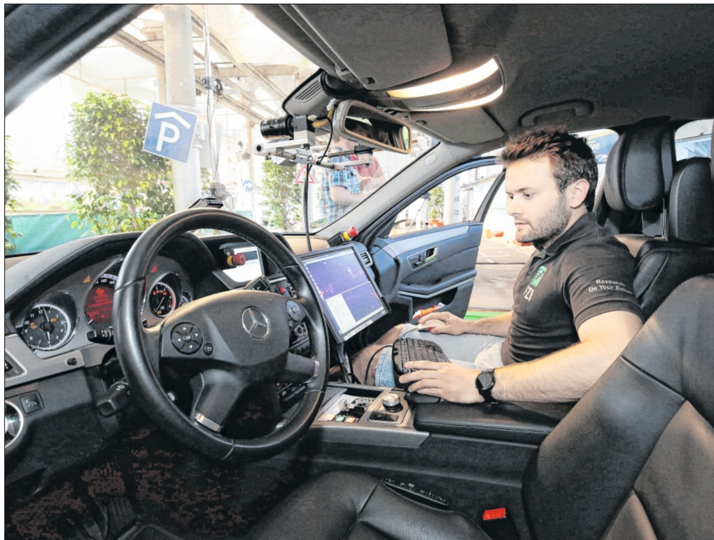
GESTEÜERT ohne Hand am Lenkrad, auch in Parkhäusern, Tempo-30-Zonen und Wohngebieten – um das zu testen wie bei dieser Demonstrationsfahrt am Alten Schlachthof, muss in der Stadt technisch viel Infrastruktur aufgebaut werden. Foto: jodo
