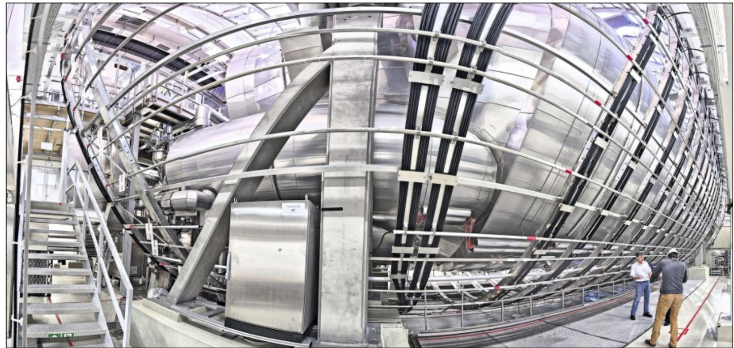
DER GIGANTISCHE BAUCH der Neutrino-Waage „KATRIN“ ist 24 Meter lang und hat einen Durchmesser von zehn Metern. Im Innern des Millionen Euro teuren Edelstahlbehälters schufen die Wissenschaftler das größte Hochvakuum der Erde. Foto: Hora
